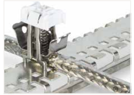
Ekran sıkıştırma modül kontakları ekran iletkeni ve özel yarıkli DIN rayı (790-145). Lütfen rayın altındaki ara modülü (790-144) kullanın.
