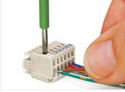
(2,5 x 0,4) mm tornavidayla bir iletken yerleştirme. iletken girişine dik çalışma
