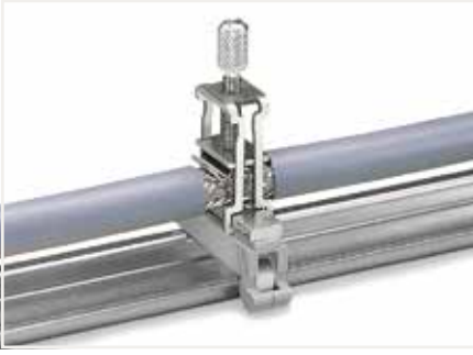
Topraklama ayaklı taşıyıcı * (790-113), 45 mm uzunluğunda, DIN rayına 90 ° bara
